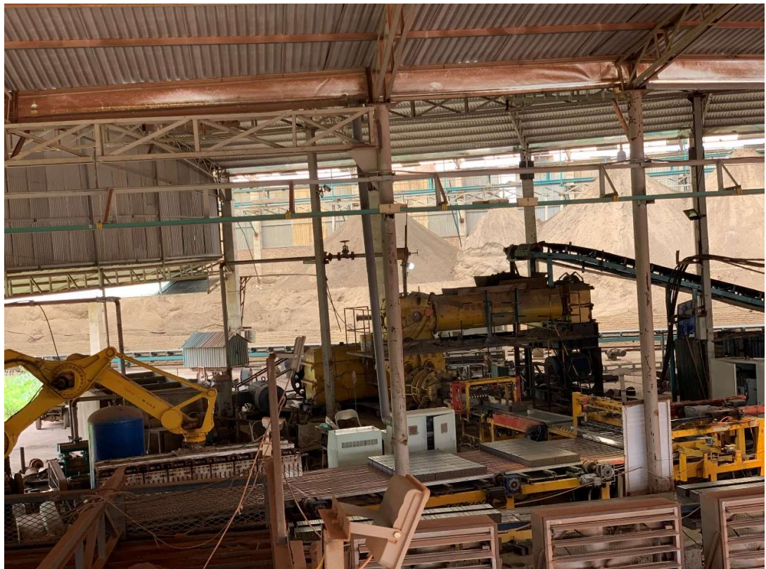
Hình 2: Công nghệ đùn ép tự động của dây chuyền lò tuynel di động
