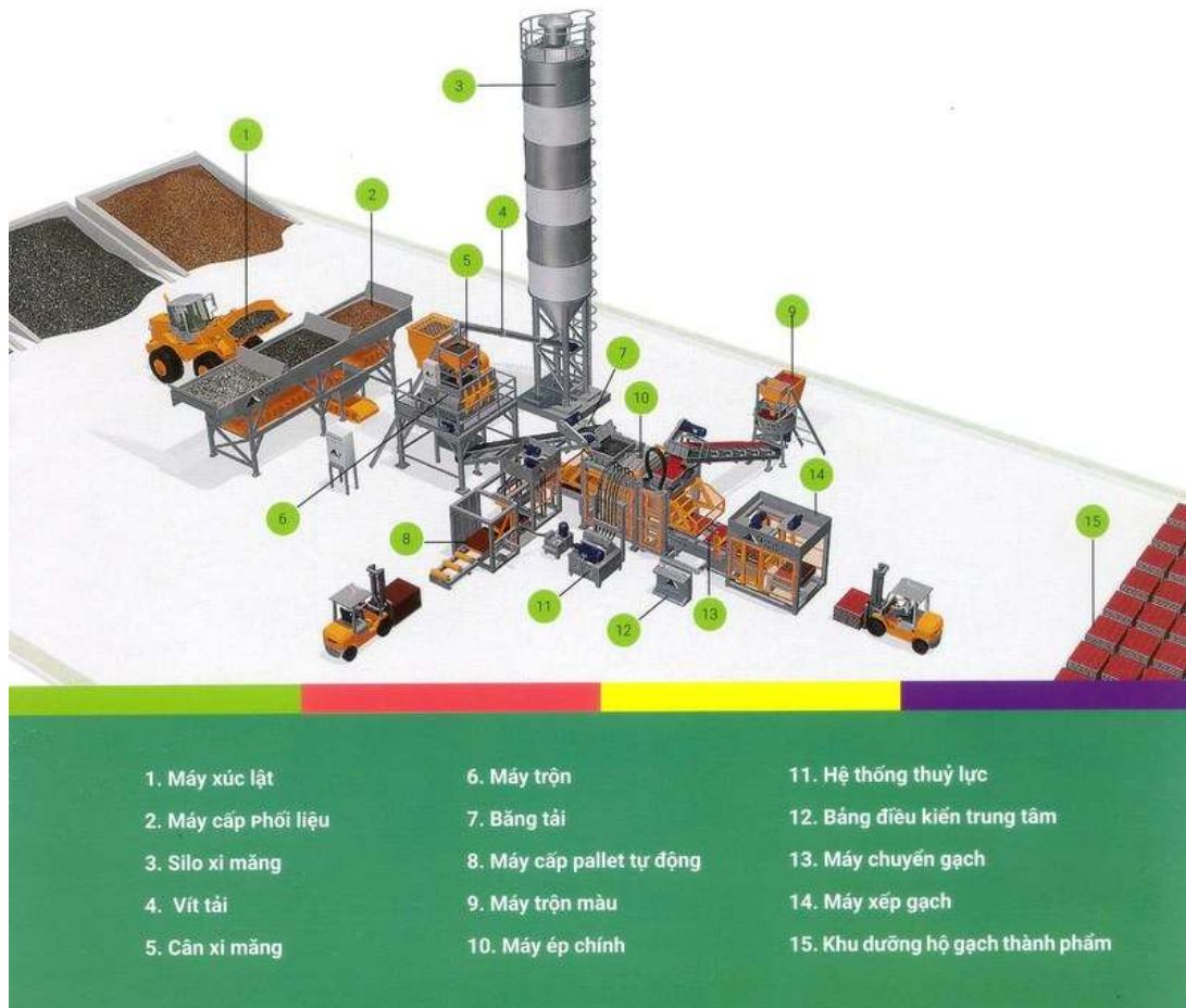
Hình 4: Sơ đồ dây chuyền công nghệ sản xuất gạch xi măng cốt liệu
